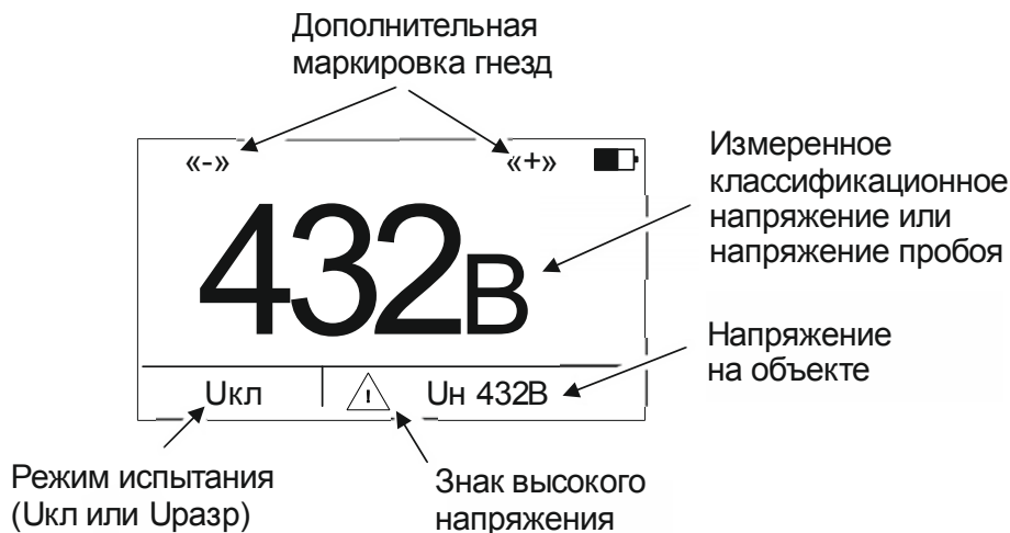
Рисунок 25 - Измерение квалификационного напряжения или напряжения пробоя разрядника
